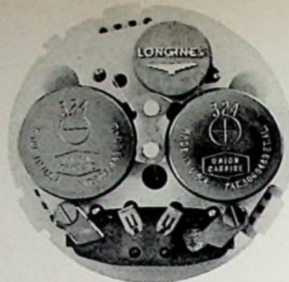
Afb. 3. Kwartskristal (onder op de foto) en kwikcellen zijn bij de LCD van Longines ondergebracht op een kunststoffreempje.
